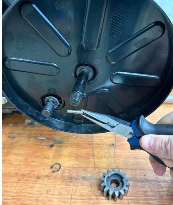
Entnehmen Sie den Spannstift mit einer Zange. Reinigen Sie anschließend alle Komponenten mit einem geeigneten Tuch oder gegebenenfalls mit Schleifpapier. Ersetzen Sie defekte Teile, falls erforderlich.
