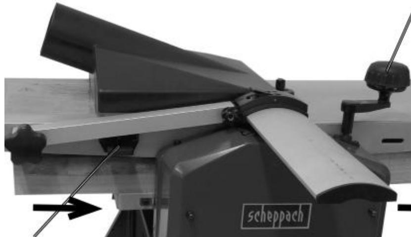
Ohne die richtige Montage der Absaugvorrichtung läuft das Gerät nicht an. Die Sicherheitsschalter verhindern das Starten des Gerätes, um Verletzungen zu vermeiden. In Ihrer Anleitung ist die Montage der Absaugvorrichtung nochmals beschrieben.
