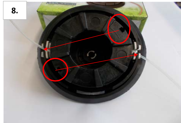
8. Faden aus den arretierungen der Spule nehmen, und entgegengesetzt in die Öffnungen des Spulenkopfes stecken.
