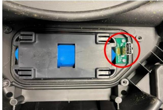
Stecken Sie nun den USB-Stick in die Schnittstelle und schalten Sie Ihren Roboter ein. Warten Sie nun bis im Display des Roboters der Schriftzug USB erscheint. Nun können Sie den USB-Stick entfernen und die aktuelle Softwareversion wurde installiert.
